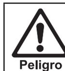
Pulverizar sólo materiales de recubrimiento con un punto de inflamación de 21°C o superior.
